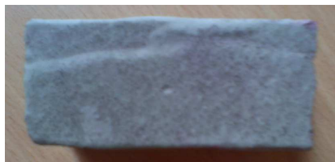
Рис. 4. Фотографії поверхні зразка з дрібнозернистого бетону, покритого гідроізоляційним розчином проникної дії, а потім просоченого розчином фенолфталеїну
