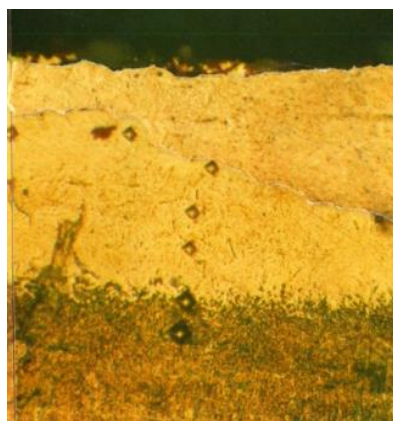
Рис. 5. Зміна мікротвердості по перерізу зразка після ТФЗ за режимом оброблення поверхні № 2 (Сталь 65Г, x250)
