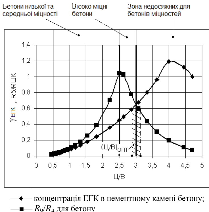
Рис. 8. Графіки залежності концентрації електрогетерогенних контактів ЕГК і відношення R_b/R_c від C/V для бетону
