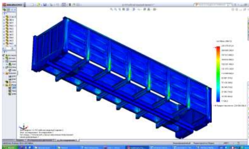
Рис. 4. Розподіл полів напружень у конструкції кузова
