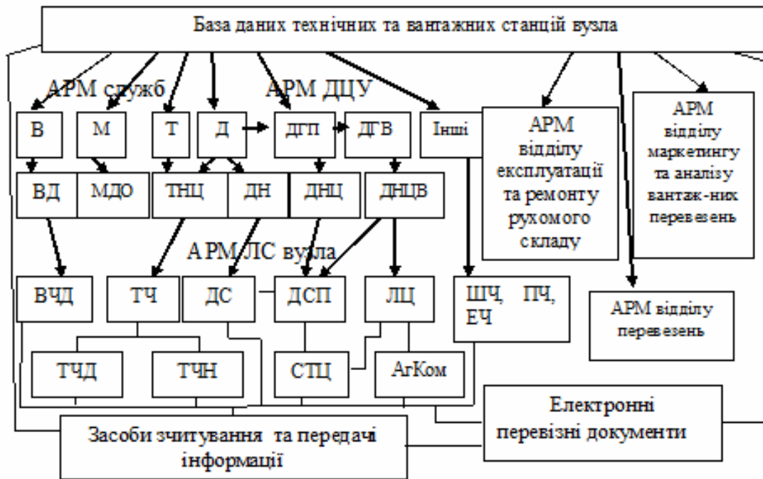
Рис. 4. Структурна схема комплексу технічних засобів «Автоматизованої системи керування станційними процесами на основі підвищення ефективності використання інфраструктури при вантажних перевезеннях»
