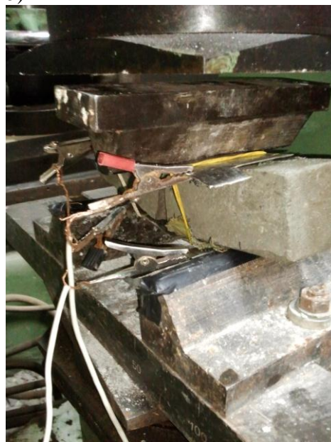
Рис. 2. Испытание образцов на изгиб при воздействии внешнего электрического поля: а – схема испытания: 1 – плиты пресса; 2 – образец-балочка; 3 – составной электрод «+»; 4 – электрод «-»; 5 – ткань, пропитанная насыщенным раствором медного купороса; б – разрушенный в результате испытания образец
