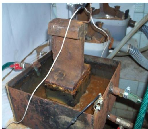
Рис. 6. Лабораторная установка для исследования влияния ПОЭП в водонасыщенном состоянии бетона: а – схема установки: 1 – программируемый блок управления; 2 – реле; 3 – источник питания; 4 – электрод; 5 – рельс Р65; 6 – металлическая ёмкость; 7 – трубка подачи воды; 8 – бетонный образец покрытый составом ЗС-3; 9 – поток воды; 10 – измерительные приборы; 11 – ПЭВМ; б и в – образец и часть установки для лабораторных исследований
