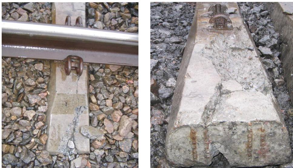
Рис. 1. Трещины в железобетонной шпале со креплением типа КПП5
