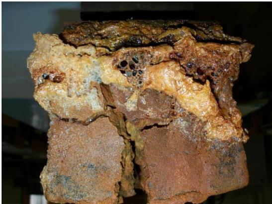
Рис. 7. Лабораторный образец: а – образование трещин на нижней грани (подошва) образца после 400 ч обработки током; б – увеличенный фрагмент а); в – образование трещины на боковой грани образца после 400 ч обработки током; г и д – состояние образца перед разрушением (5000 ч) соответственно, нижняя грань (подошва) и боковая грань
