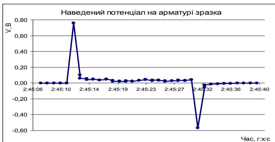
Рис. 9. Потенціал, наведений зовнішнім пульсуючим постійним електричним полем 5 кВ, на арматурі неекранованого зразка ( V_{\max} = 0,755 В, V_{\min} = -0,568 В)
