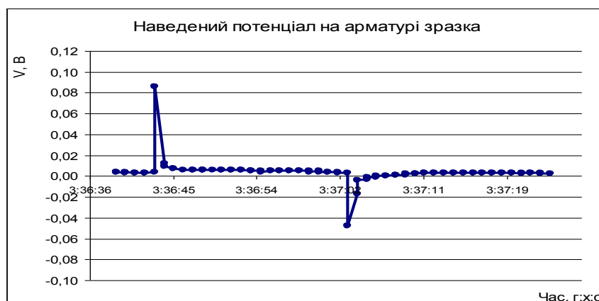
Рис. 13. Потенціал, наведений зовнішнім пульсуючим постійним електричним полем 5 кВ, на арматурі екранованого алюмінієвою фольгою зразка ( V_{\max} = 0,086 В, V_{\min} = -0,048 В)
