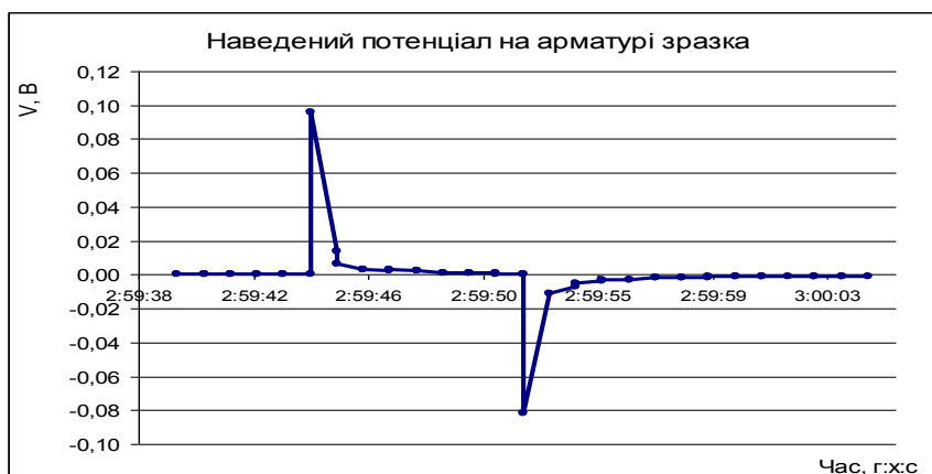
Рис. 12. Потенціал, наведений зовнішнім пульсуючим постійним електричним полем 5 кВ, на арматурі екранованого сталевую сіткою зразка ( V_{\max} = 0,102 \text{ B} , V_{\min} = -0,082 \text{ B} )
