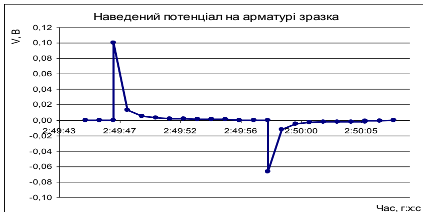
Рис. 10. Потенціал, наведений зовнішнім пульсуючим постійним електричним полем 5 кВ, на арматурі екранованого сталевим листом зразка ( V_{\max} = 0,1 \text{ B} , V_{\min} = -0,067 \text{ B} )
