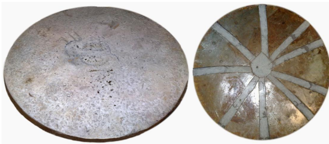
Рис. 3. Характер разрушения сталебетонной плиты П-1
