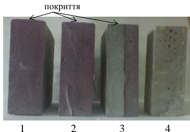
Рис. 5. Фотографії поверхні зламу зразків дрібнозернистого бетону, які після 7 діб твердіння були захищені покриттям розробленого складу (1), а потім оброблені спиртовим розчином фенолфталеїну; покриттям «Пенетрон» (2) з наступною обробкою розчином фенолфталеїну; покриттям розробленого складу (3) з наступною його обробкою розчином \text{BaCl}_2 ( \frac{1}{2} поверхні) і спиртовим розчином фенолфталеїну ( \frac{1}{2} поверхні); як аналог прийнято зразок без покриття (4) з нанесеним розчином фенолфталеїну
