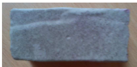
Рис. 4. Фотографії поверхні зразка з дрібнозернистого бетону, покритого гідроізоляційним розчином проникної дії, а потім просоченого розчином фенолфталеїну
