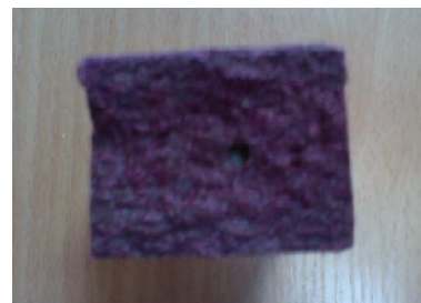
Рис. 3. Фотографії поверхні зламу зразків дрібнозернистого бетону, просочених розчином фенолфталеїну: а – без нанесення гідроізоляційного покриття; б – з нанесеним гідроізоляційним покриттям
