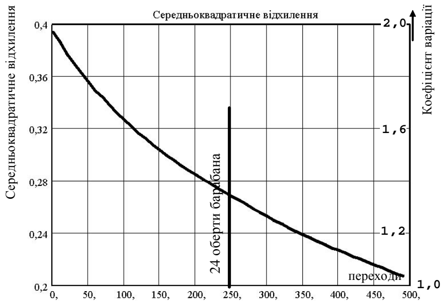
Рис. 6. Змінювання коефіцієнта варіації в ході переробки
