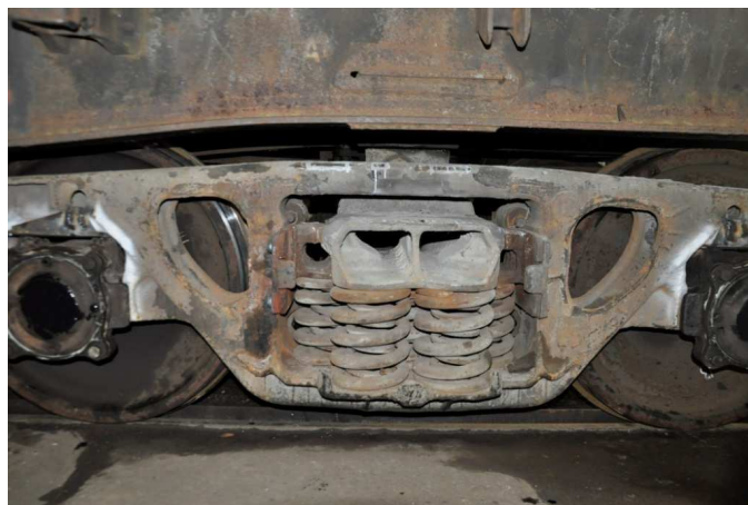
Рис. 2. Общий вид расположения фрикционных клиньев в тележке модели 18-100
