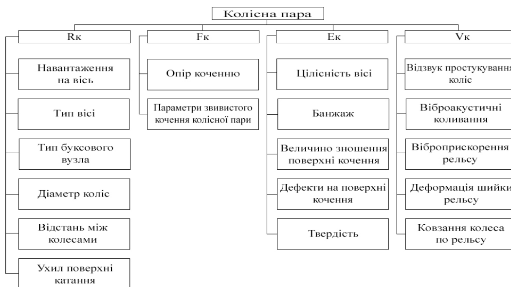
Рис. 7. Діагностична модель колісної пари
