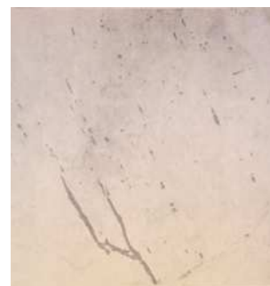
Рис. 6. Розвиток розгалуженої поздовжньої тріщини по неметалевих вкрапленнях
