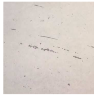
Рис. 3. Неметалеві вкраплення всередині головки рейки, поздовжній переріз
