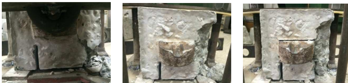
Рис. 7. Випробування моделей шпал динамічним (ударним) навантаженням: a – схема копра для випробувань; б–e – моделі шпал з пошкодженнями: первинними тріщинами ( б, в , бетон класу С35/45 і С40/50 відповідно); первинним відколом, значними відколами, повним руйнуванням з відділенням анкера від бетону ( г, д, e відповідно бетон класу С20/25)
