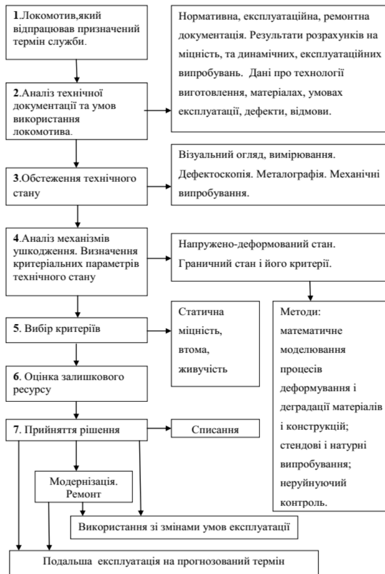
Рис. 1. Структурна схема процедури визначення залишкового ресурсу і продовження терміну служби
