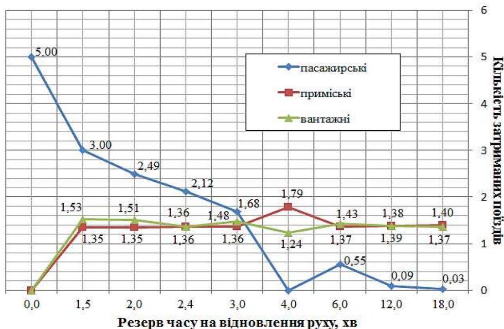
Рис. 1. Залежність кількості затриманих поїздів різних категорій від зміни величини резерву часу на відновлення руху пасажирських поїздів
