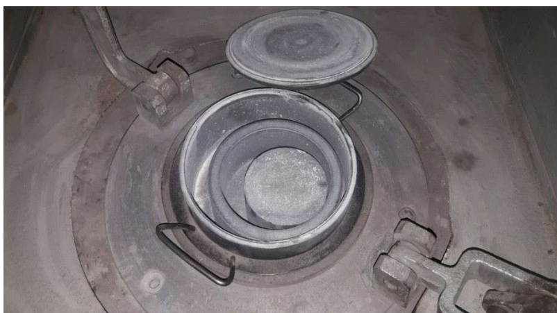
Рис. 2. Вібраційний млин для подрібнення графіту
