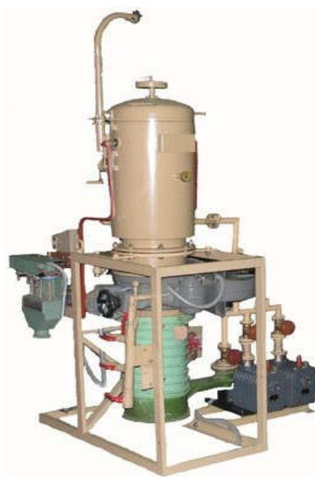
Рис. 7. Вакуумна піч СШВЕ-1,25
