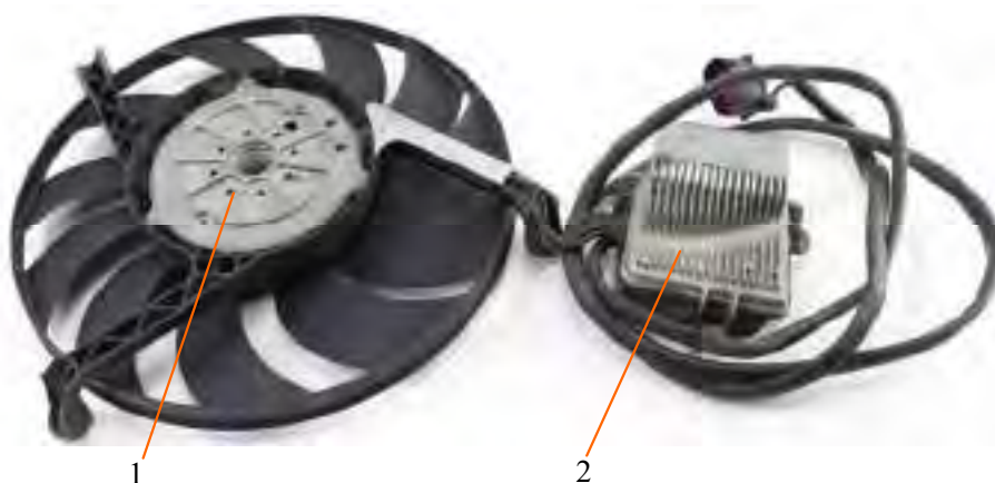
Рис. 2. Вентилятор 3D 0959 453D (3D 0959 453E) фірми TEMIC СО серії 1-3.71.80: 1 – двигун вентилятора; 2 – блок керування двигуном
