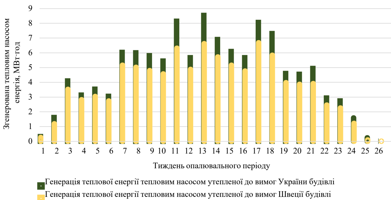
Рис. 5. Генерація теплової енергії тепловим насосом протягом опалювального періоду при покращенні теплової оболонки будівлі відповідно до вимог України і Швеції
