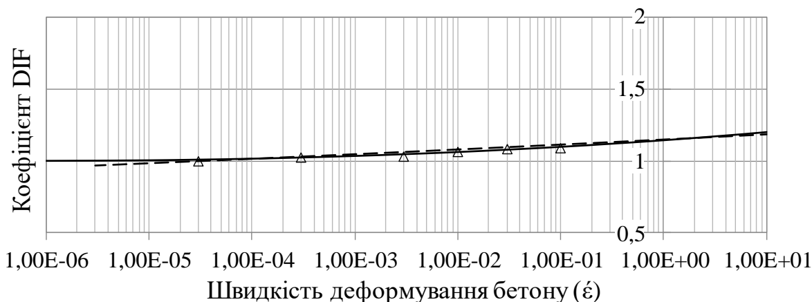
Рис. 6. Залежність DIF від швидкості деформування бетону міцністю f_c = 110,8 \text{ MPa} : \Delta – за дослідями [27]; — — за формулою (7); — — — за СЕВ-FIP [8]
