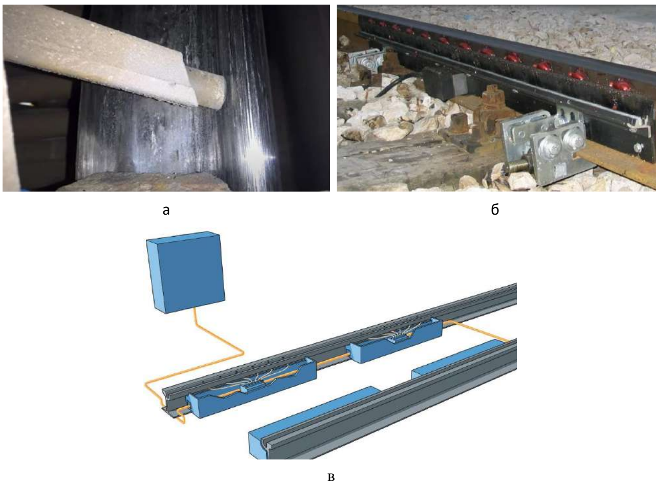
Рис. 1. Технології подавання в зону контакту «третього тіла»: а – мастильними стрижнями для змащення реборди; б – стаціонарними системами, які підводять мастильний матеріал через щітки; в – стаціонарними системами, які підводять мастильний матеріал через головку рейки
