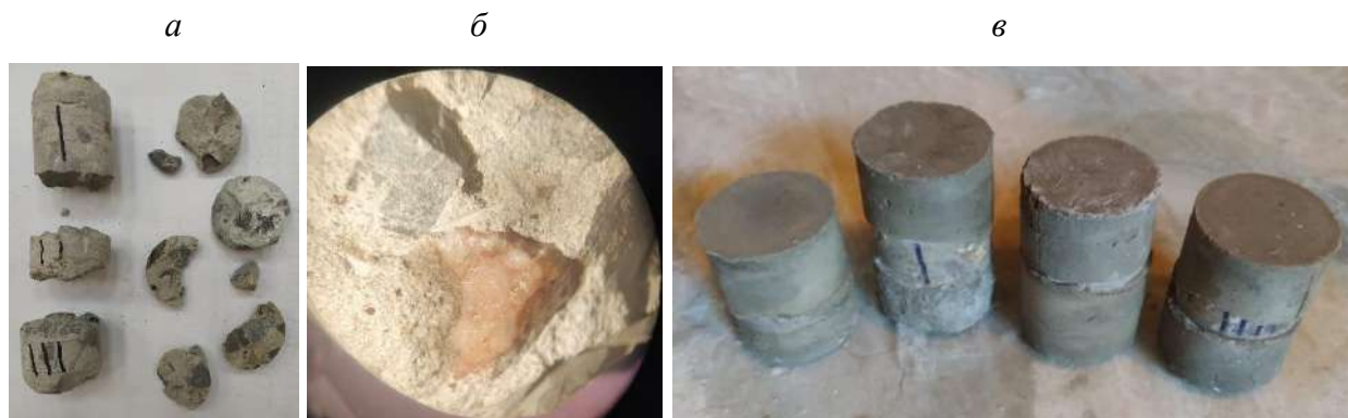
Рис. 4. Зразки-керни: а – загальний вигляд керна; б – відкол, світловий мікроскоп, \times 12,5 , частинка сірого кольору – вапняк, рожевого – кварц; в – підготовлені для випробування на міцність зразки
