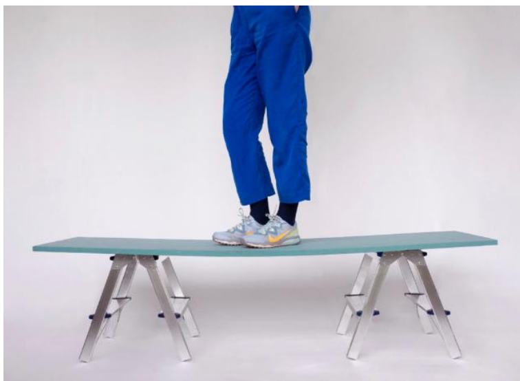
Рис. 2. Демонстрація міцності пластини з деревного композита на казеїновому клеї товщиною 15 мм (за даними проєкту «Superwood»)
