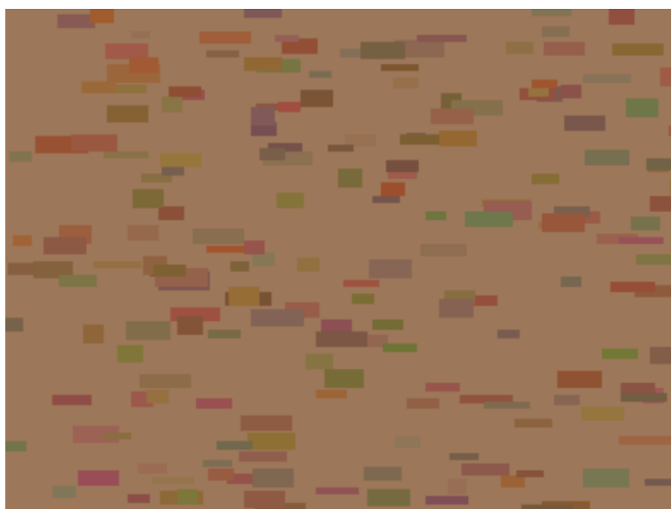
Рис. 1. Зовнішній вигляд біокompозитного матеріалу (імітація поверхні цегли з казеїнового клею та деревної стружки)
