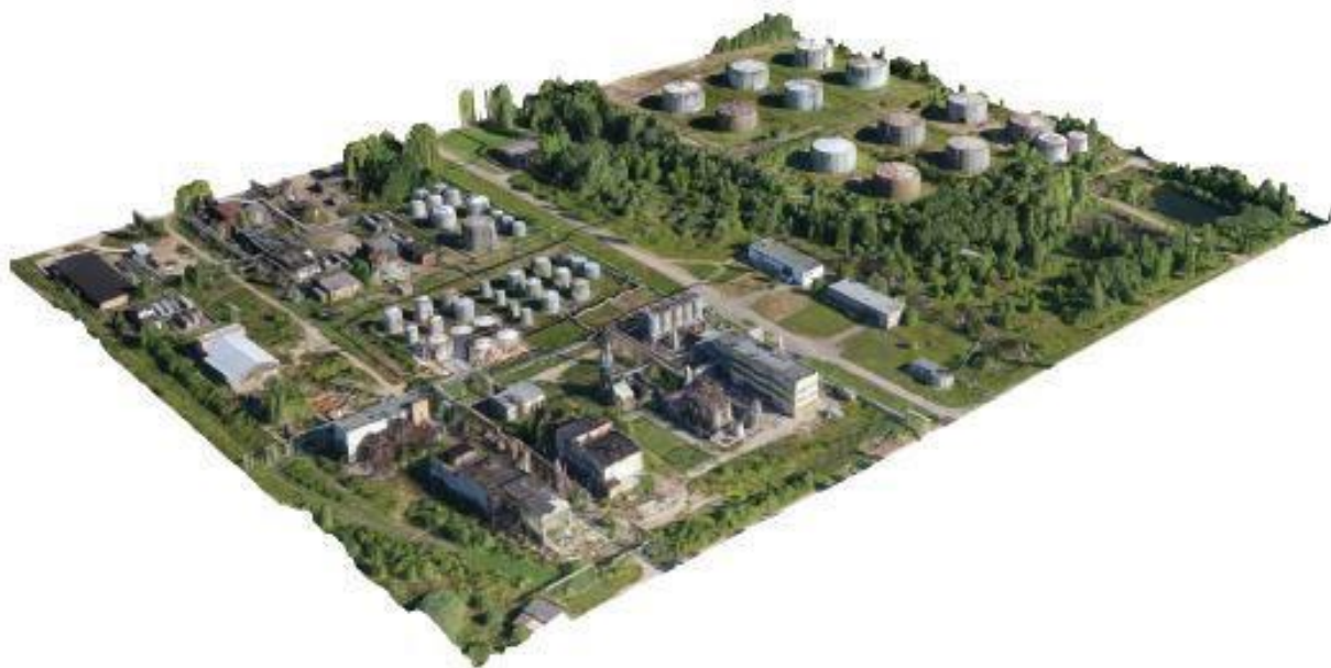
Рис. 5. Тривимірна модель місцевості, сформована в результаті обробки даних цифрового знімання з БПЛА (отримано авторами)
