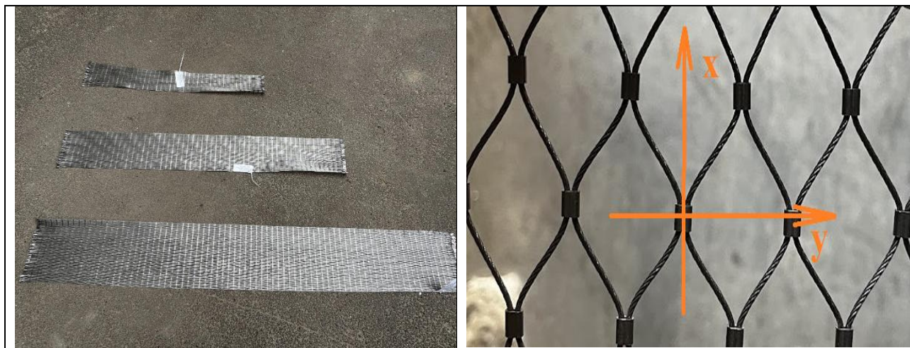
Рис. 3. Зовнішній вигляд зразків сіток: а – фрагменти сіток у транспортному положенні; б – комірки сіток у робочому положенні
