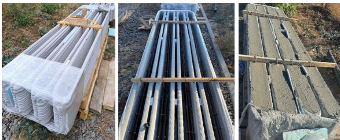
Рис. 5. Зразки залізобетонних балок з інтегрованою незнімною опалубкою, виготовленою за технологією 3D-друку (3DCP)
