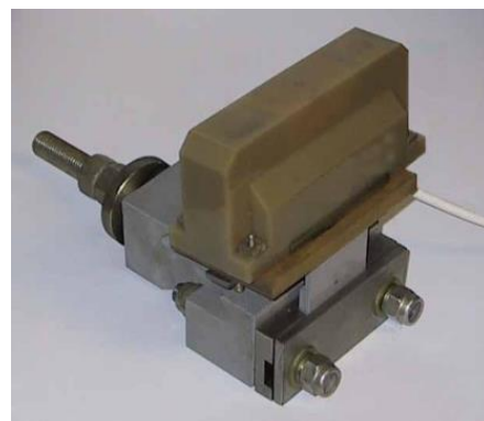
Рис. 11. Зовнішній вигляд датчика для фіксації проходження коліс по колії
