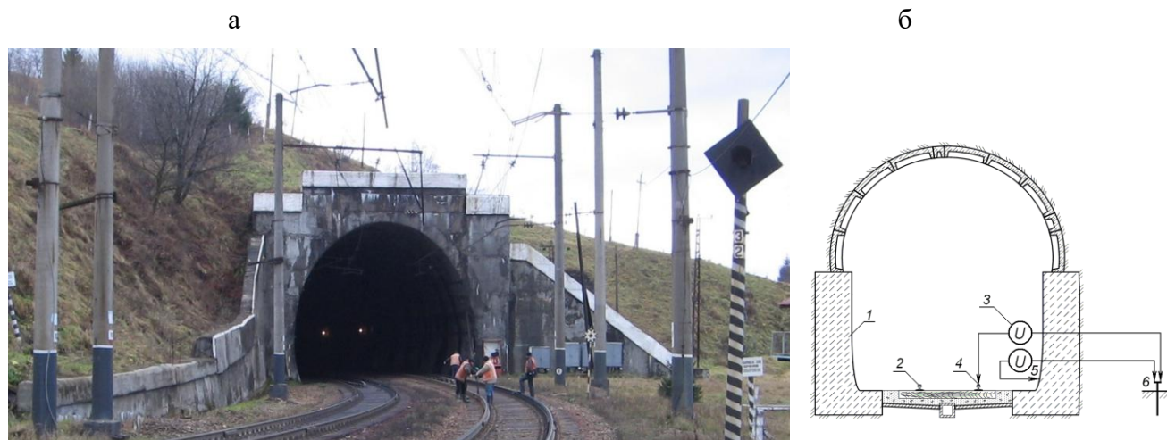
Рис. 6. Вимірювання потенціалів на рейці та поверхні оправи тунелю: а – тунель на електрифікованій постійним струмом ділянці Львівської залізниці; б – схема вимірювання; 1 – оправа тунелю; 2 – рейкова колія; 3 – вимірювальні прилади (цифрові мультиметри Sanwa PC510); 4 – кріплення провідника вимірювальної схеми до рейки затискачем; 5 – мідно-сульфатний електрод; 6 – заземлюючий електрод (сталевий стрижень \varnothing 12 мм, забитий у вологу землю на глибину 0,5 м на відстані не ближче 25 м від порталу тунелю)
