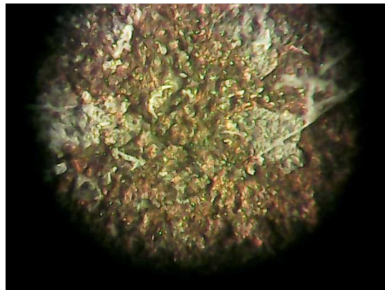
Рис. 2. Стан поверхонь після насичення на зразку, борованого з пасти Г. Видно червоні проміжки міді та недорозчинені частинки B_2O_3 (х 90)
