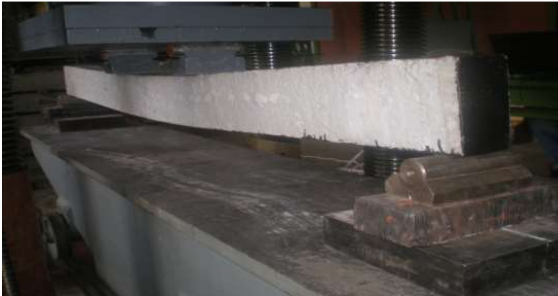
Рис. 5. Характер деформування балок
