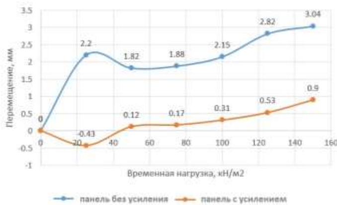
Рис. 24. Остаточные деформации панелей после разгрузки.
