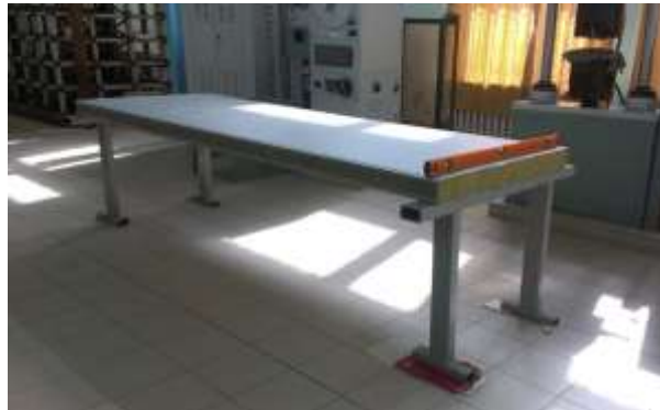
Рис. 3. Трехслойная панель второго типа (с армирующими элементами из просечно-вытяжного листа). Общий вид.
