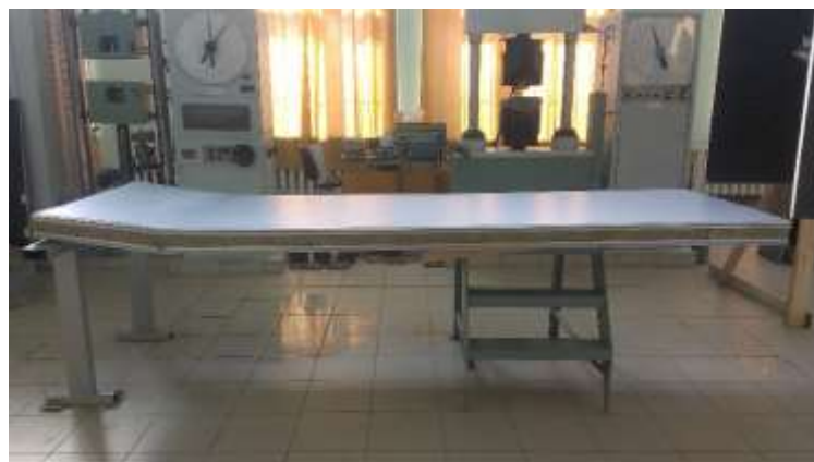
Рис. 27. Общий вид разрушенной панели первого типа
