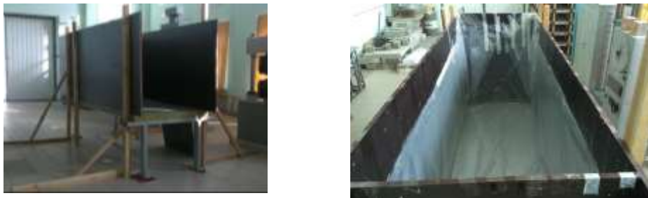
Рис.5. Общий вид резервуара для нагружения панели.
