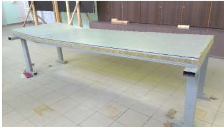
Рис. 28. Общий вид разрушенной панели второго типа
