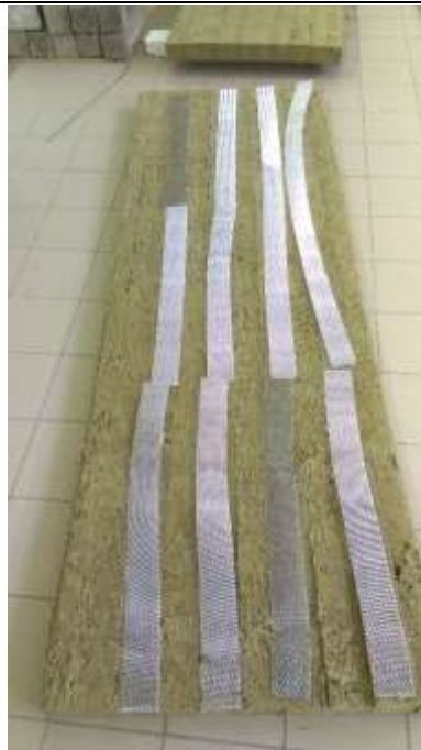
Рис. 25. Деформированные просечно-вытяжные армирующие элементы
