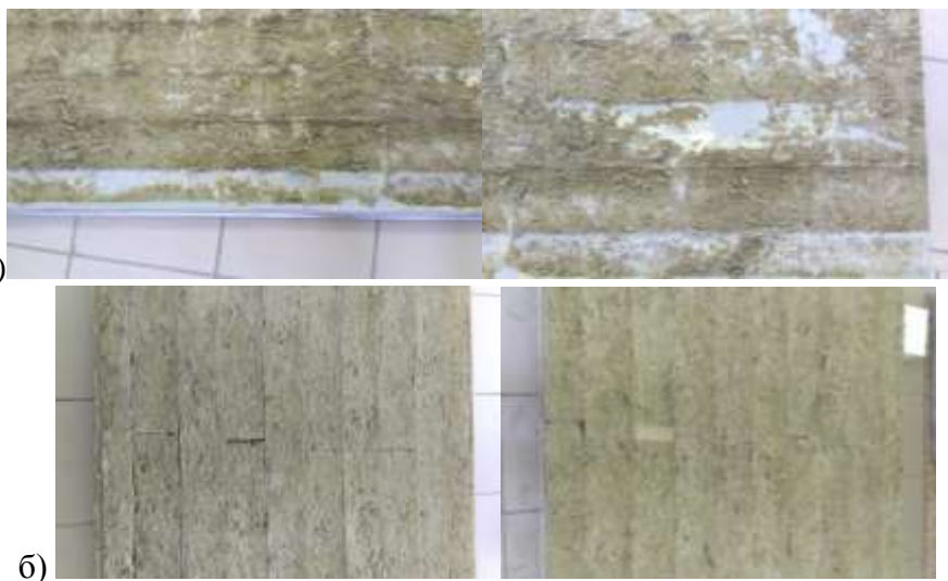
Рис. 26. Начальные несовершенства, установленные после разрушения панелей: а) непрочней обшивок; б) поперечные стыки.
