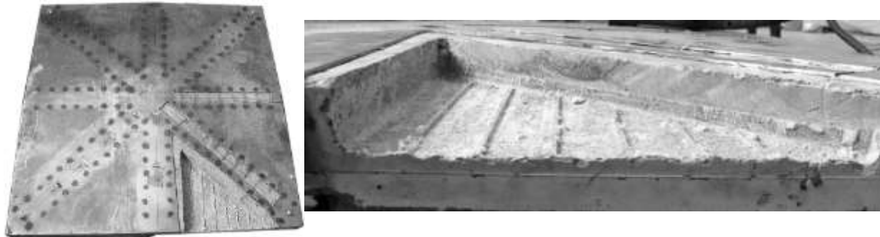
Рис. 7. Розкрита після випробувань пустота зразка СПБ50.
