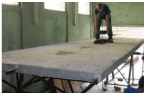
Рис. 3. Динамические испытания пролетного строения
