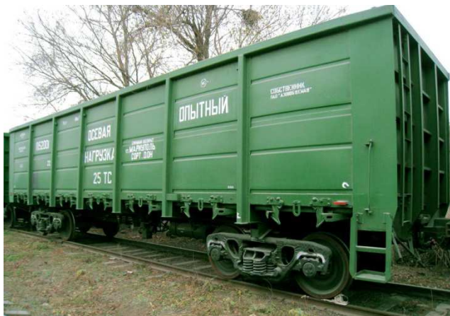
Рис. 3. Піввагон нового покоління побудови ПАТ «Азовмаш» з осьовим навантаженням 25 т
