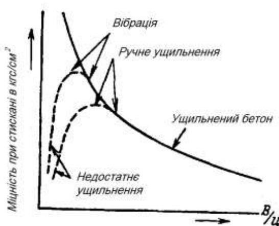
Рис. 2. Залежність міцності бетону від В/Ц [4]
