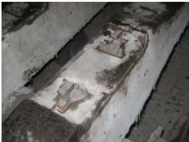
Рис. 11. Виготовлення шпал Ш1-1-PRS на Коростенському ЗЗБШ:
