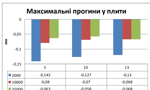
Рис. 4. Максимальні величини напруг і деформацій, які виникають в плиті БМП в залежності від модуля деформації (пружності) прокладного шару та сили затягування шпильок
