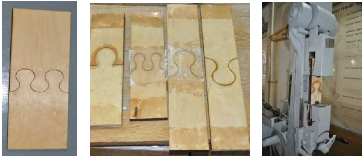
Рис. 9. Испытательные образцы фанерных полос с одним и двумя пазлами
