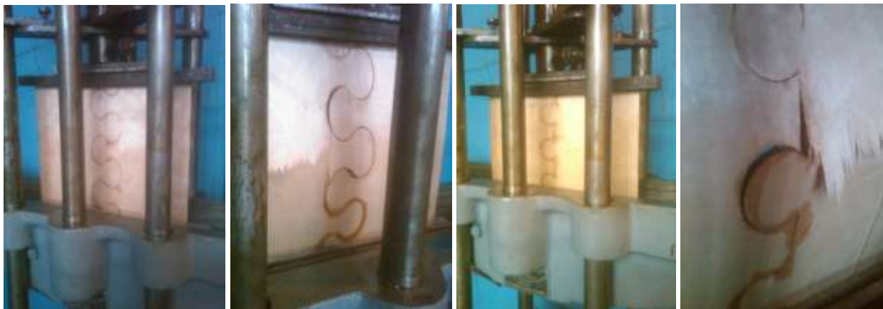
Рис. 10. Разрушение сжато-изгибаемых фанерных пластин
