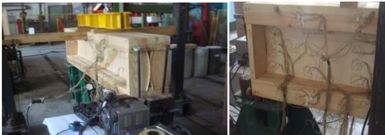
Рис. 2. Экспериментальный образец X-образной балки
