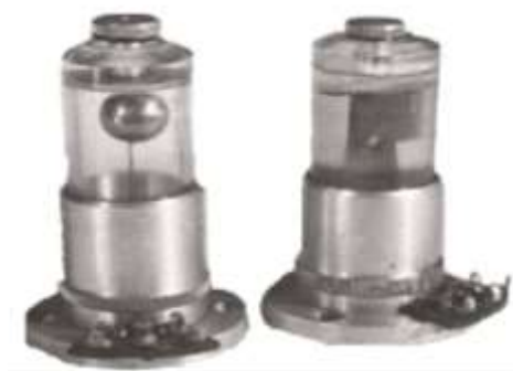
Рис. 1. Вібродатчик ІС-312 С з жидкісним демпфуванням
