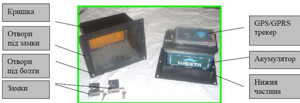
Рис. 2. Елементна база навігаційного пристрою GPS
