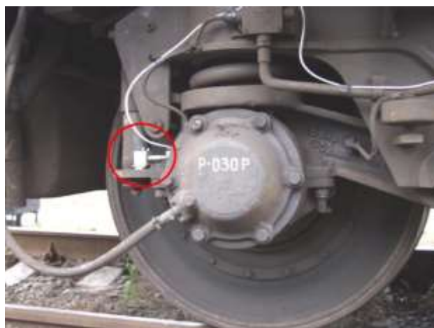
Рис. 2. Ходова частина вагона з п'єзоелектричним датчиком
