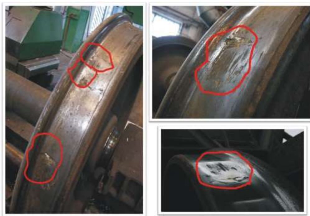
Рис. 1. Пошкодження поверхні кочення коліс
