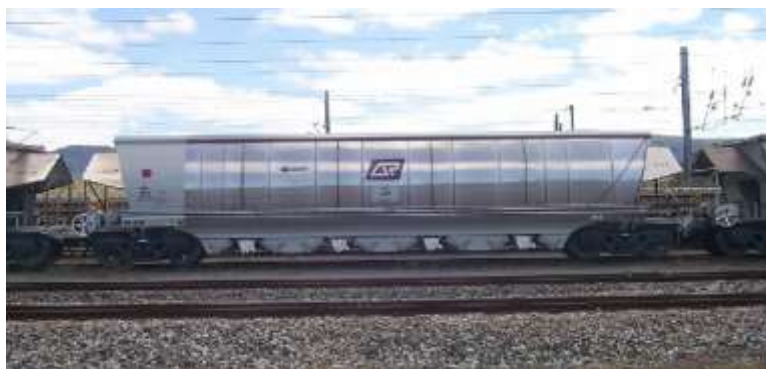
Рис. 3. Вагон австралійських залізниць, обладнаний підшипниковим вузлом з дворядним касетним конічним підшипником (осьове навантаження 270 кН)
