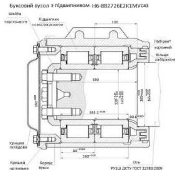
Рис. 4. Буксовий підшипниковий вузол вагона з дворядним касетним циліндричним підшипником (СВУ)
