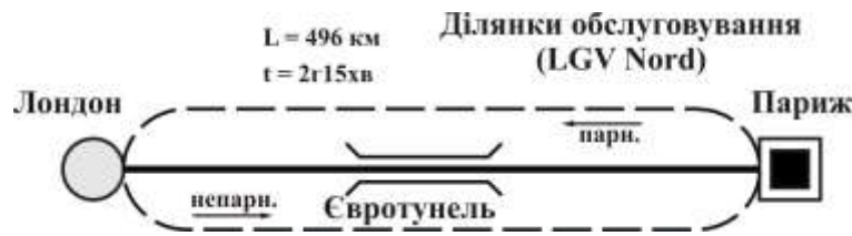
Рис. 7. Схема ділянки обороту поїздів Євростар
