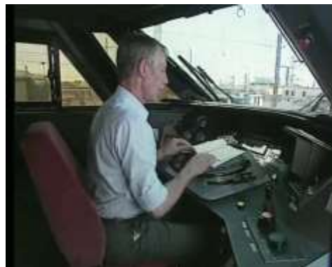
Рис. 2. Перевірка машиністом вимикачів центрального щита управління в кабіні (а) і бортової сервісної документації (б)
