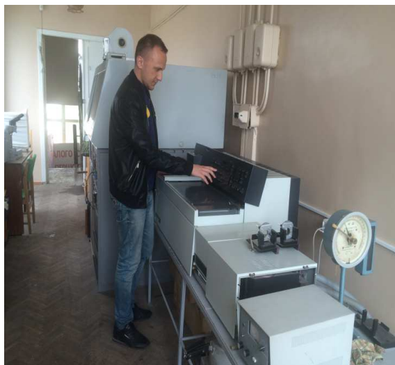
Рис. 7. Рабочая установка спектрофотометра SPECORD M80 и снятие показаний ультрафиолетовых спектров поглощения ММА
