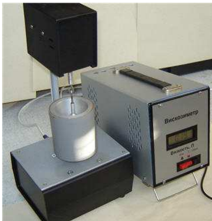
Рис. 1. Рабочая установка ротационного вискозиметра марки ВА.1
