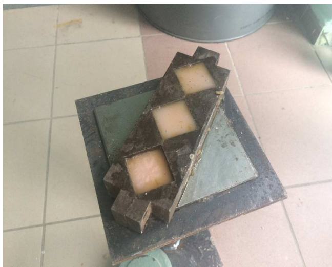
Рис. 6. Заливка образцов растворной смеси ММА в металлическую опалубочную форму в лаборатории кафедры строительных конструкций ХНУГХ имени А.Н. Бекетова
