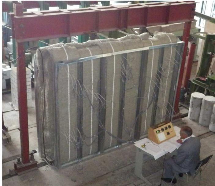
Рис. 2. Роздвіжні рами з теплоізолятором - матами з мінеральної вати для створення двовимірного температурного поля в образці
