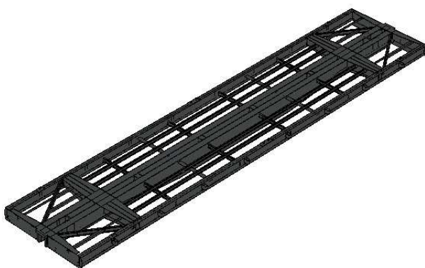
Рис. 1. Несуча конструкція вагона-платформи моделі 13-4012 з урахуванням заходів щодо її удосконалення: а – просторова модель; б – модель міцності
