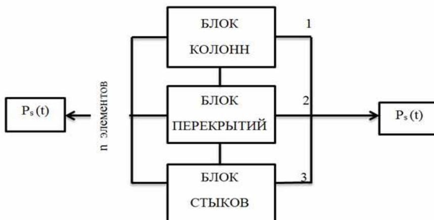
Рис. 2. Модель соединения группы основных несущих элементов многоэтажного каркасного здания ( $n=3$ )
