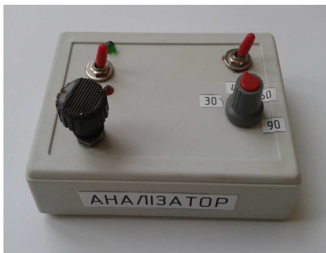
Рис. 1. Макетний зразок пристрою акустичного контролю та імітатор звука взаємодії колеса з рейкою
