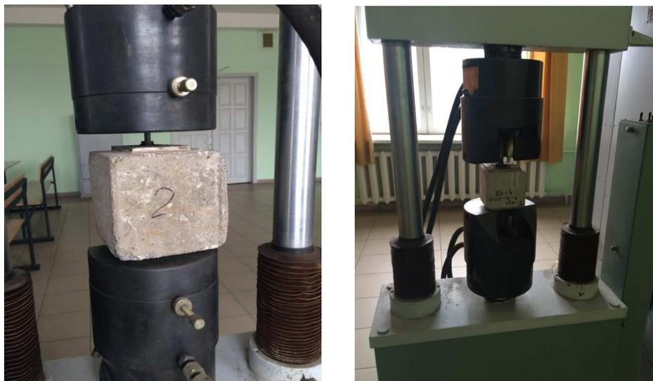
Рис. 4. Испытания образцов клеевых соединений на разрывной машине марки МР-1000 в лаборатории кафедры строительных конструкций Харьковского национального университета городского хозяйства имени А. Н. Бекетова
